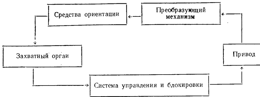
Рис. 17. Замкнутая структурная схема средств автоматизации листоштамповочного производства
